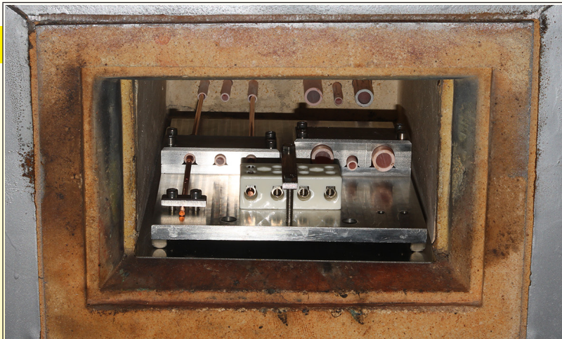
作为温度函数用于陶瓷电阻率的测试烤箱 (Ultimheat 实验室)
